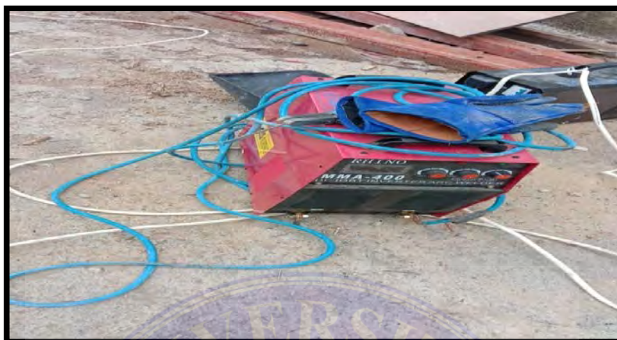
Gambar 3.6 Mesin Las Sumber : Dokumentasi
