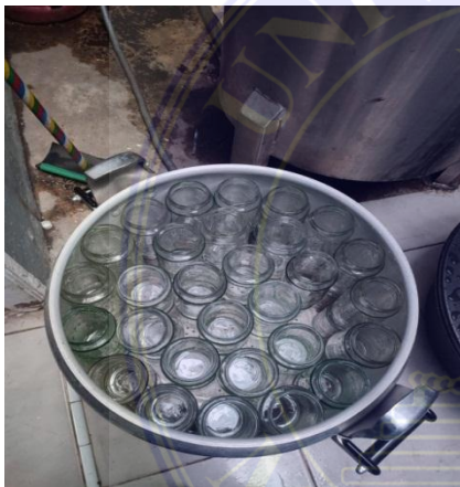
c. Proses sterilisasi botol kultur dan alat di dalam autoklaf dengan tekanan 17,5 Psi dan suhu 121°C
