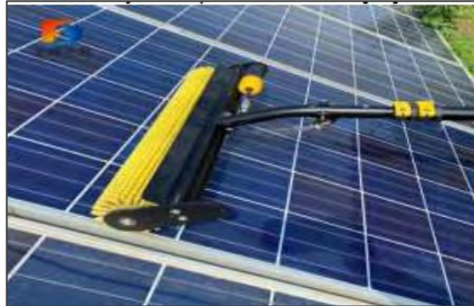
Gambar 2.3 Sapu dengan Air dan Sikat Berputar Vertikal Gold Dasion
