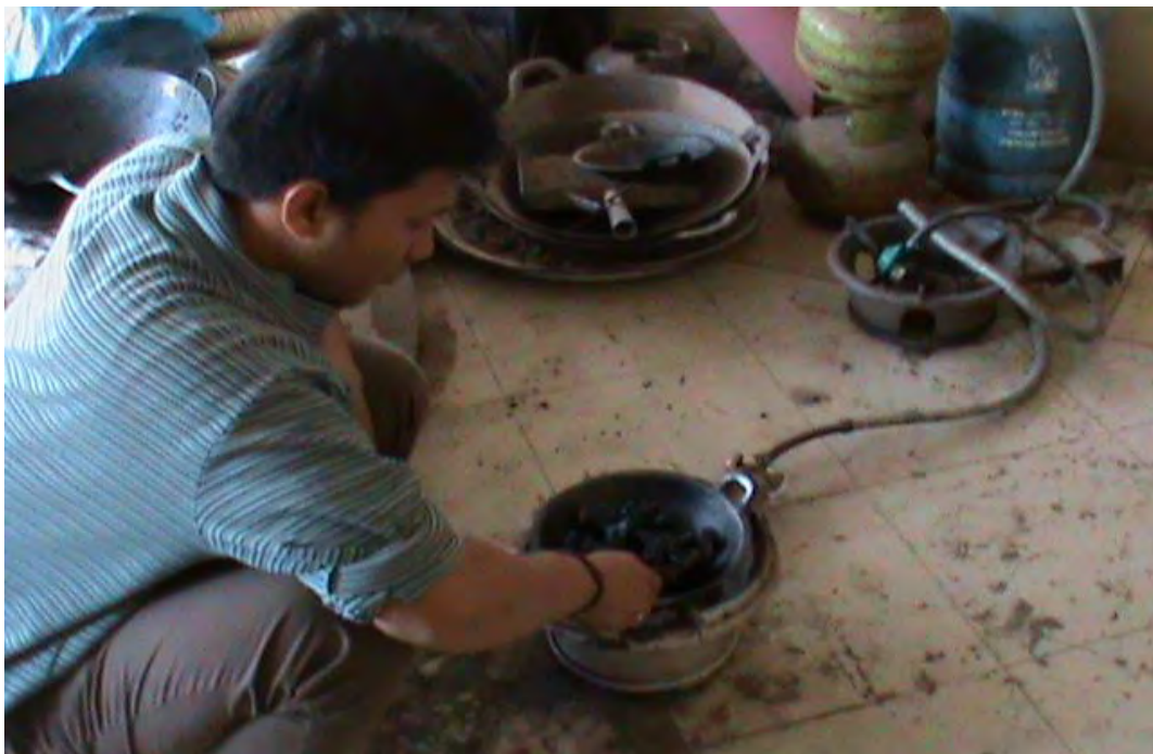
Gambar 11. Pemanasan Benda Uji (Aspal)
