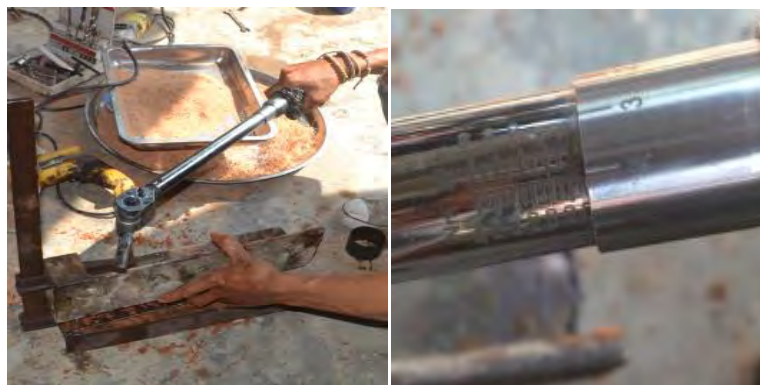
Gambar 2.14 Penekanan dengan kunci torsi
