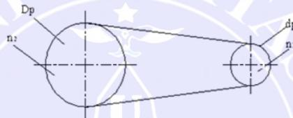
Gambar 2.8. Sistem transmisi
