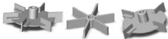
Gambar 2.3 Pengaduk Turbin pada bagian variasi
