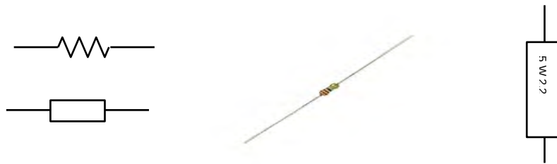
Gambar 2.2 Lambang dan bentuk komponen resistor
