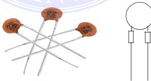
Gambar 2.5 Bentuk dan konstruksi kapasitor keramik
