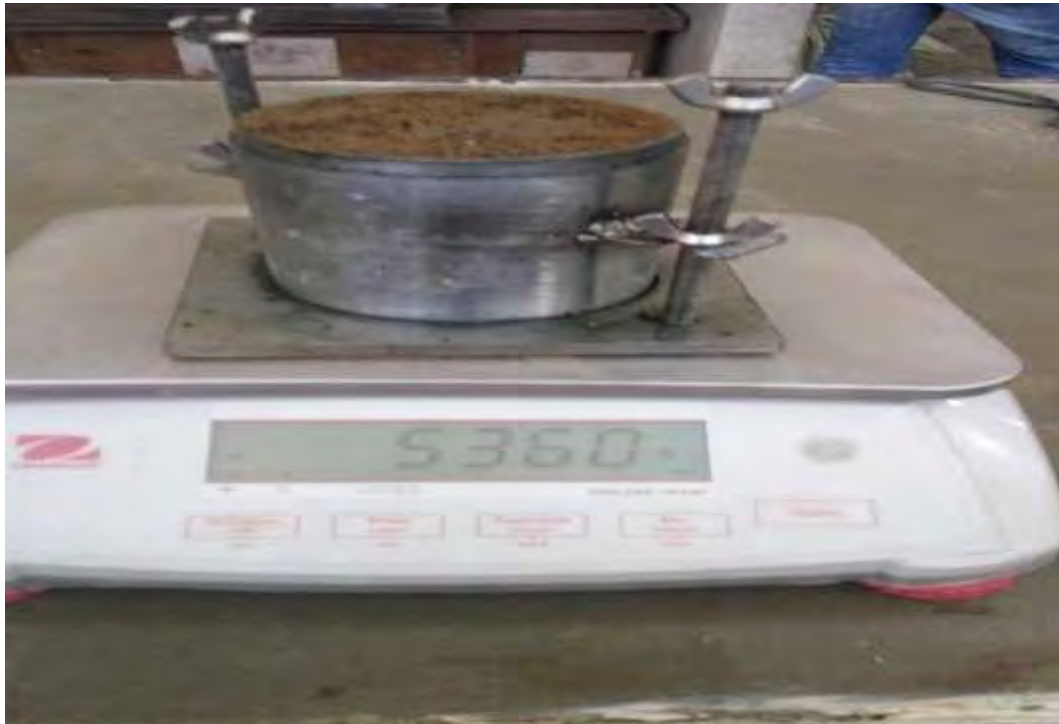
Gambar 5.16 Tahap Penimbangan Tanah Proctor Standar Sumber : Data laboratorium POLMED ,2018
