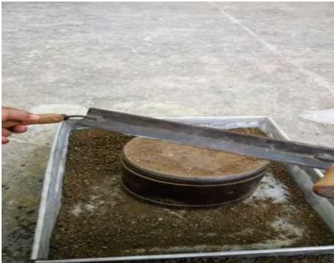
Gambar 5.22 Tahap Prataan Mold Uji CBR Sumber : Data laboratorium POLMED ,2018
