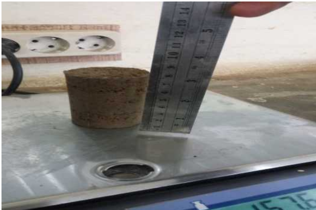
Gambar 5.33 Tahap Pengukuran Pada Tanah UCS Sumber : Data laboratorium POLMED ,2018
