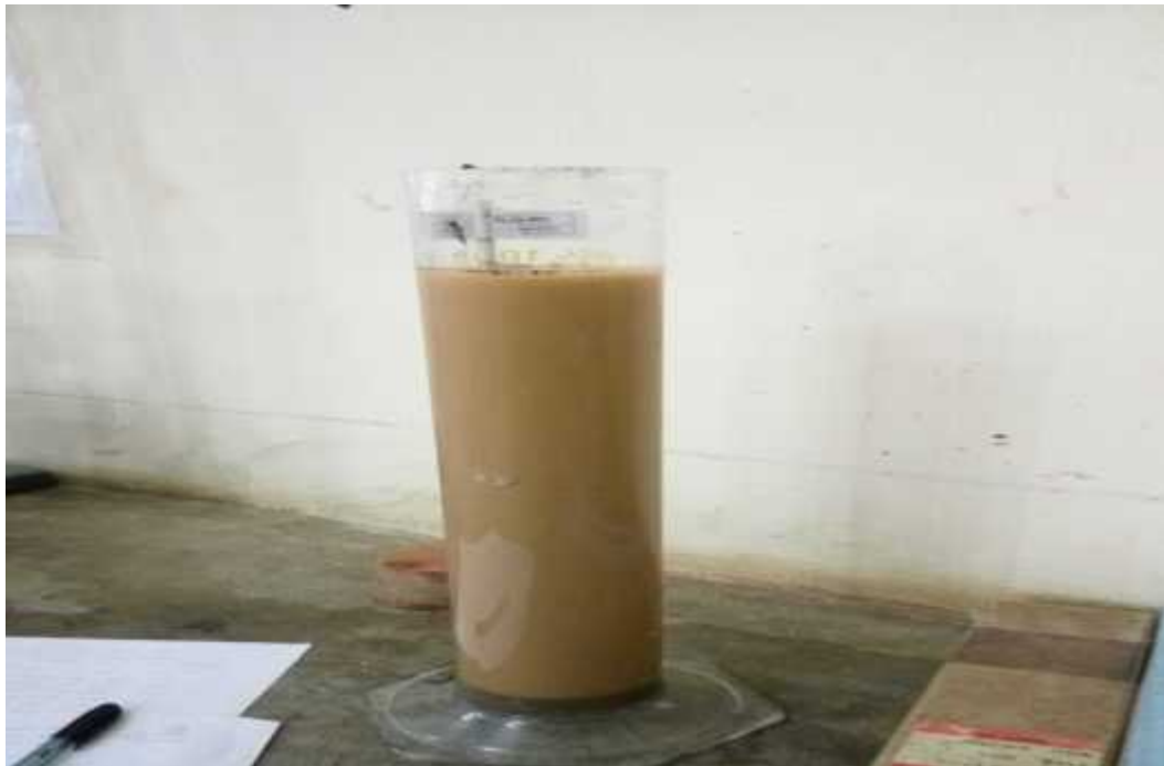
Gambar 5.31 Tahap pembacaan Pada Alat Hidrometer Sumber : Data laboratorium POLMED ,2018
