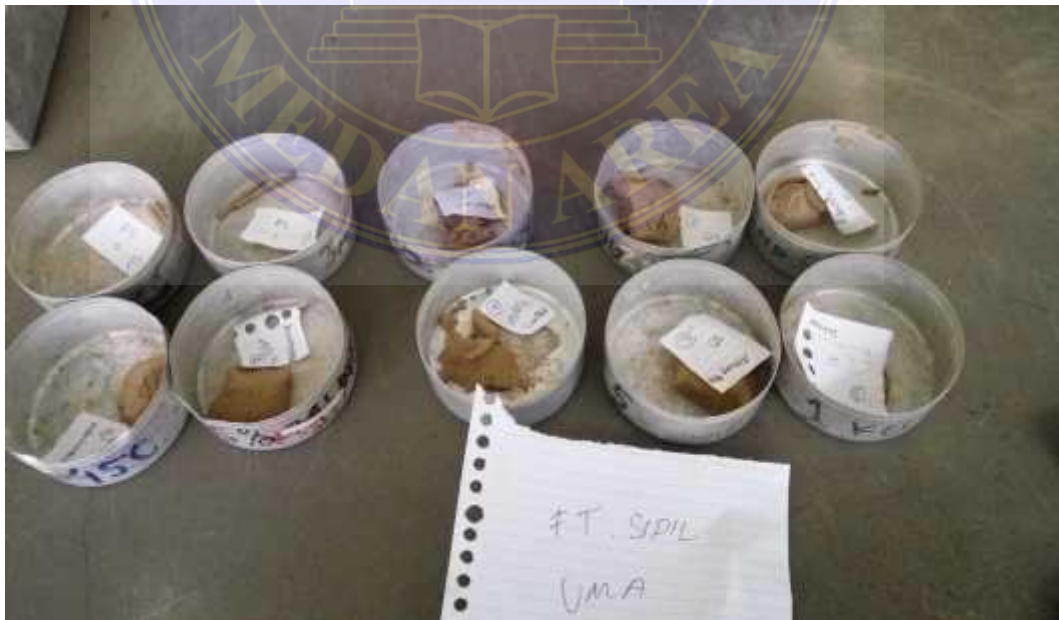
Gambar 5.10 Tahap Pengovenan Atterberg Limit Sumber : Data laboratorium POLMED ,2018
