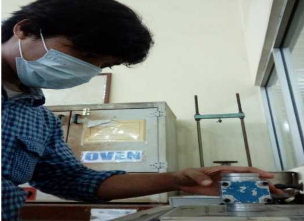
Gambar 5.32 Tahap Penimbangan Pada Alat UCS Sumber : Data laboratorium POLMED ,2018
