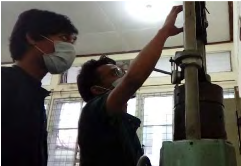
Gambar 5.26 Tahap Penentuan Dail / Bacaan alat CBR Sumber : Data laboratorium POLMED ,2018
