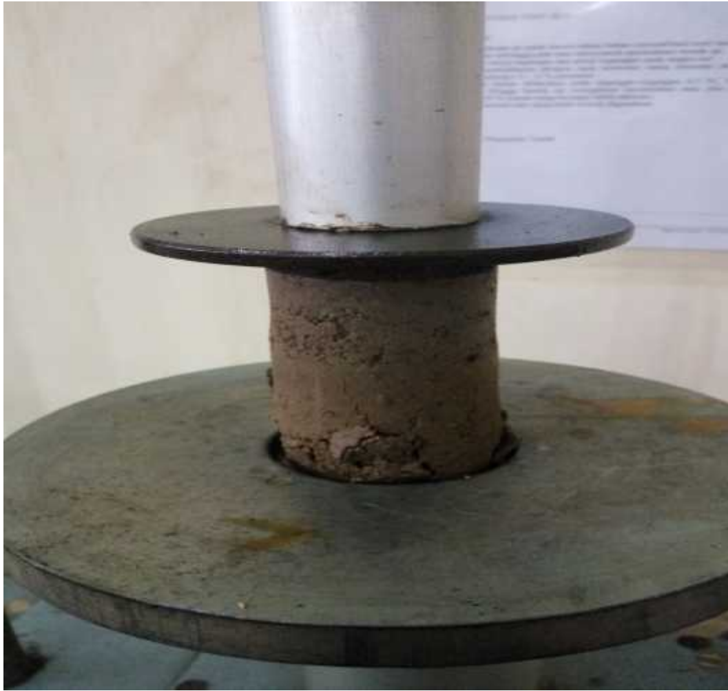
Gambar 5.34 Tahap Uji Tekan Pada Tanah dengan Alat UCS. Sumber : Data laboratorium POLMED ,2018
