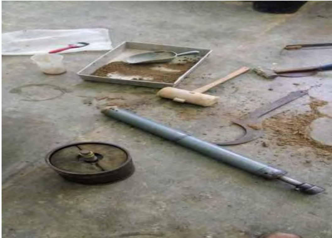
Gambar 5.23 Tahap Penambahan berat 2 kg keatas tanah Mold Uji CBR Sumber : Data laboratorium POLMED ,2018
