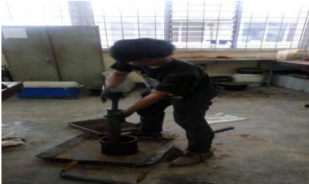
Gambar 5.21 Tahap Penumbukan Uji CBR Sumber : Data laboratorium POLMED ,2018
