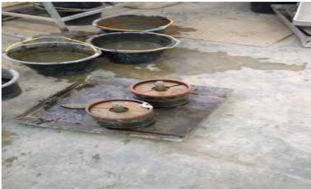
Gambar 5.24 Tahap Pemeraman Tanah Uji CBR Sumber : Data laboratorium POLMED ,2018
