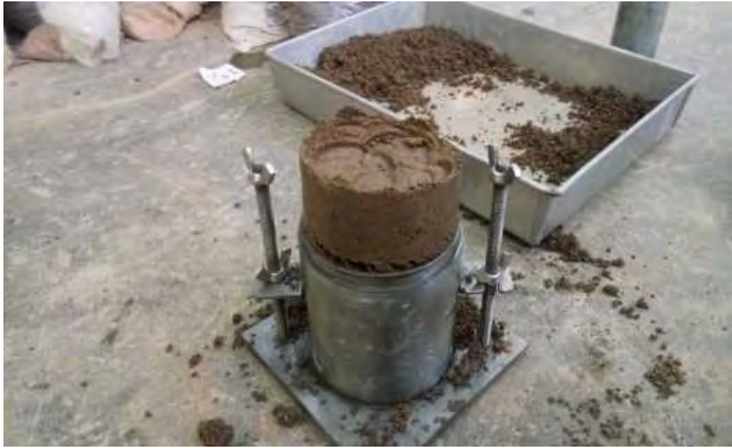
Gambar 5.15 Tahap Penumbukan Tanah Proctor Standar Sumber : Data laboratorium POLMED ,2018
