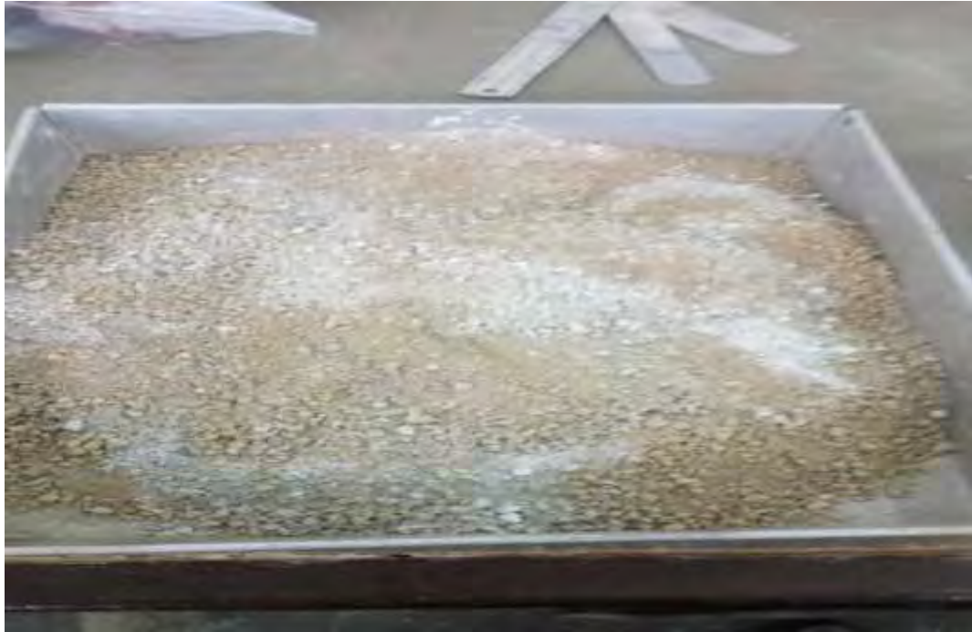
Gambar 5.19 Tahap Pencampuran bahan Tambah Gypsum dan Semen Sumber : Data laboratorium POLMED ,2018
