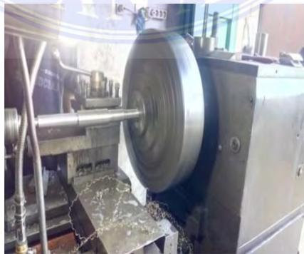
Gambar 48 Proses pembubutan batang poros
