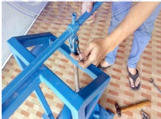
Gambar 68. Pemasangan baut dan mur
