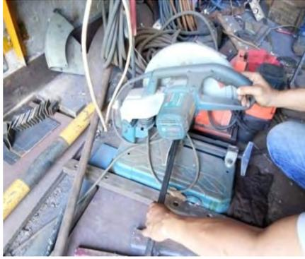
Gambar 49 Pemotongan besi hollow
