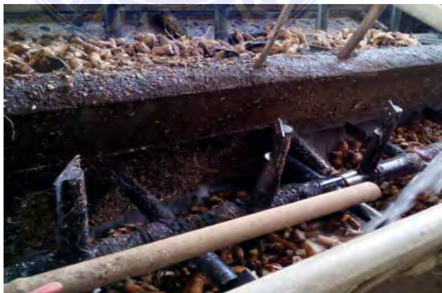
Gambar 4.5. Proses Pencucian Singkong
