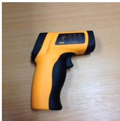
Gambar 2.9 Thermometer Infra Merah.
