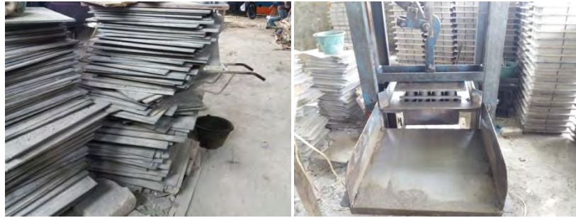
Gambar 3.3 Cetakan Batako Ukuran 30 x 8 x 15 cm.
