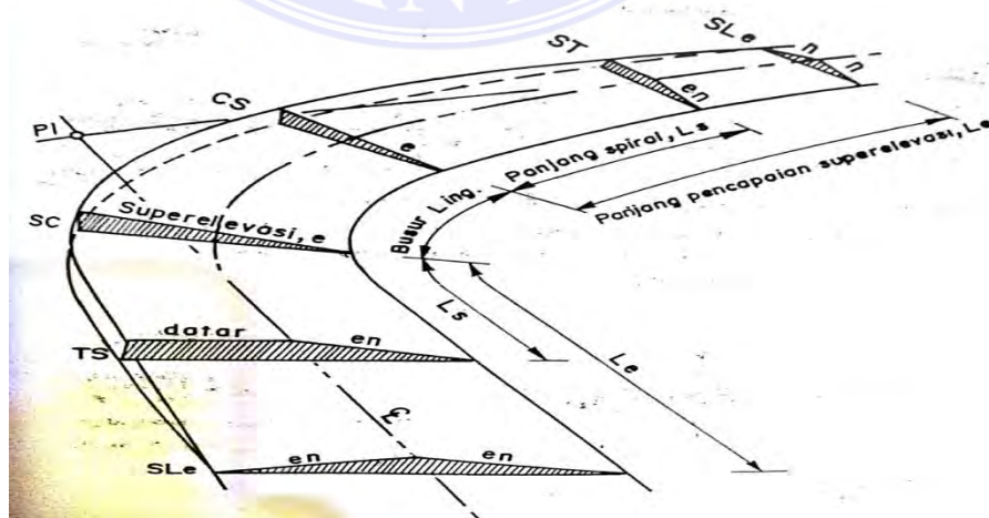
Gambar 2.10 perubahan kemiringan melintang
