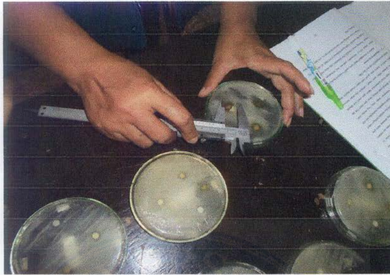
Gambar 7. Pengukuran zona hambat pertumbuhan mikroba
