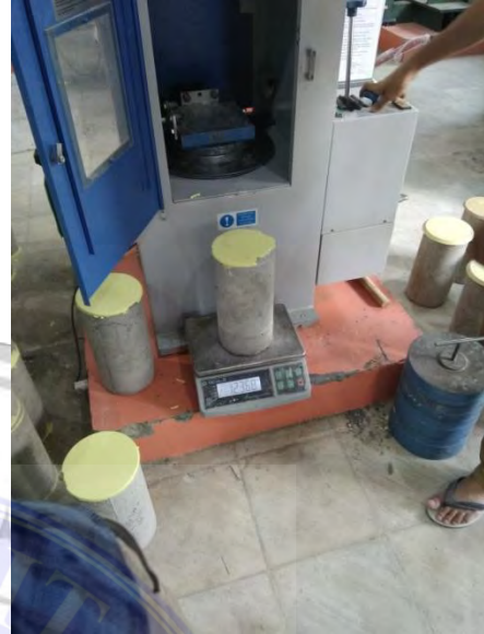
Beton ditimbang sebelum diuji
