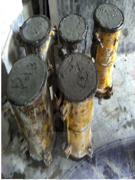
Memasukkan beton ke dalam cetakan silinder
