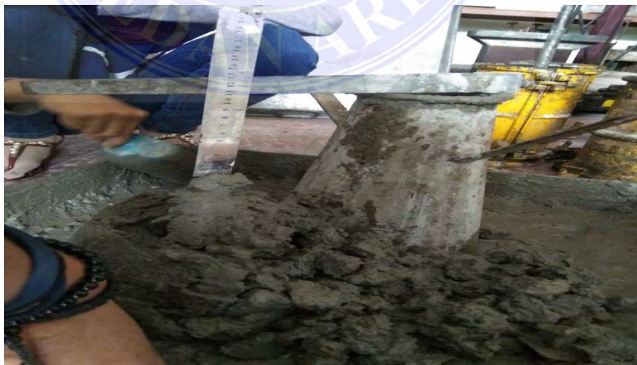
Gambar 3.3 Pengujian Slump Test
