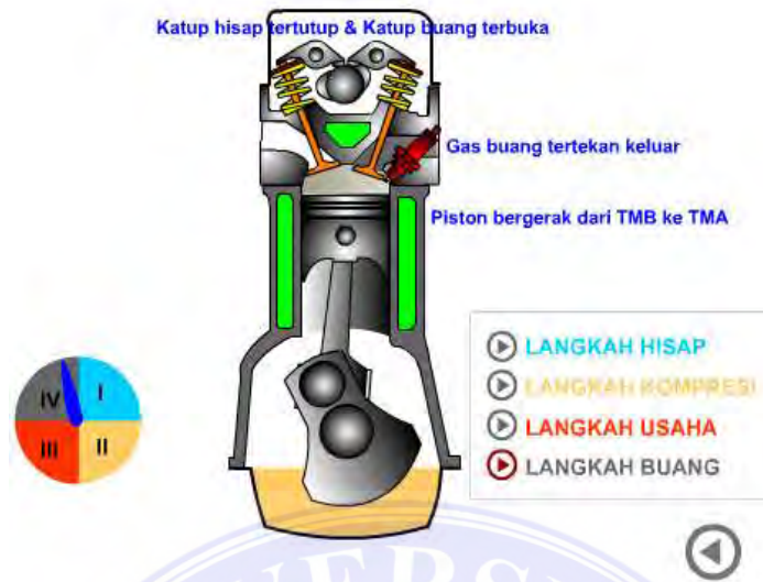
Gambar 2.4. Langkah Buang
