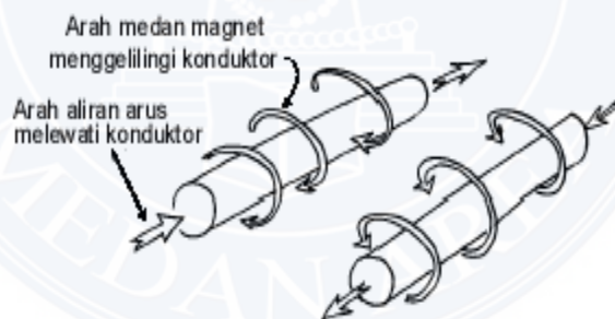
Gambar 2.9. Medan magnet dan arus yang mengelilingi konduktor
