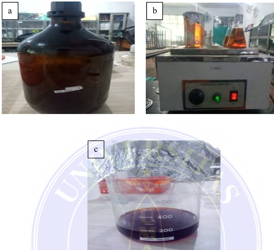
Gambar . a) Tabung reagen sebagai tempat perendaman sekaligus penyimpanan ekstrak biji alpukat. b) proses penguapan ekstrak etanol dengan menggunakan waterbath. c) ekstrak pekatan etanol biji alpukat.
