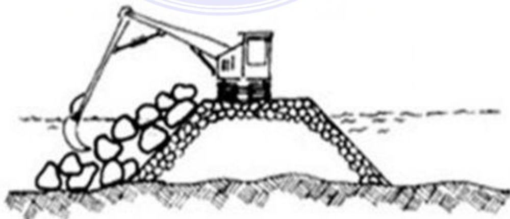
Gambar 2.13 Penempatan batuan lapisan bawah menggunakan excavator Sumber : www.google.co.id/metode+penyusunan+batu+tanggul
