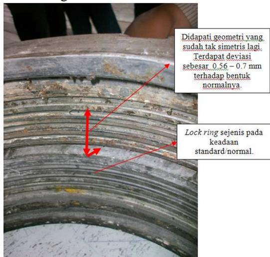
Gambar 7. Deformasi pada ulir lock ring.
