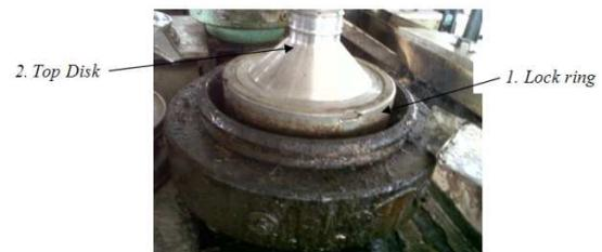
Gambar 5. Posisi lock ring dan top disk.
