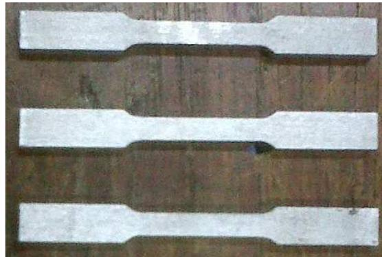
Gambar 10. Bentuk spesimen uji tarik dari bahan lock ring.
