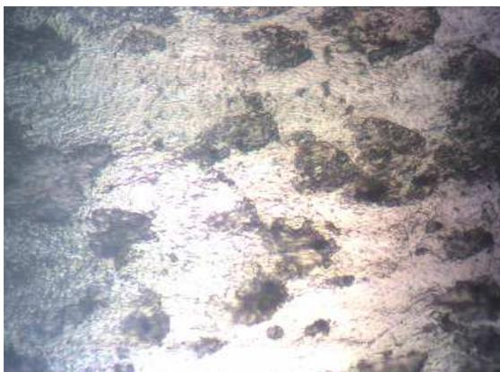
Gambar 17. Foto mikro lock ring yang mengalami kegagalan dengan perbesaran 800 kali.
