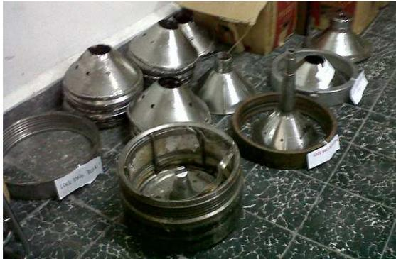
Gambar 4. Komponen-komponen centrifuge yang mengalami kerusakan.
