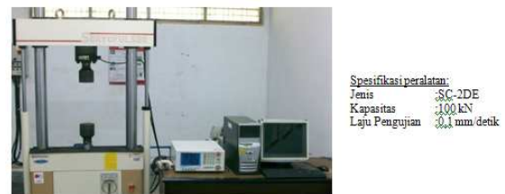
Gambar 3. Alat uji statik tekan jenis Shimadzu Servopulser
