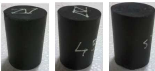
Gambar 6. Spesimen uji statik tekan untuk jenis serat arang karbon dengan masing-masing komposisi serat/resin: (a) 10/90, (b) 20/80, dan (c) 30/70
