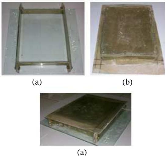
Gambar 6. Cetakan struktur penguat *parking bumper*: (a) cetakan bawah, (b) cetakan atas, dan (c) posisi pemasangan.
