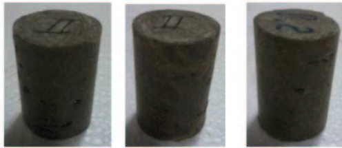
Gambar 5. Spesimen uji statik tekan untuk jenis serat rumput ilalang dengan masing-masing komposisi serat/resin: (a) 10/90, (b) 20/80, dan (c) 30/70
