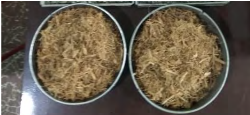
Serat Serabut Kelapa yang sudah di cacah sembarang
