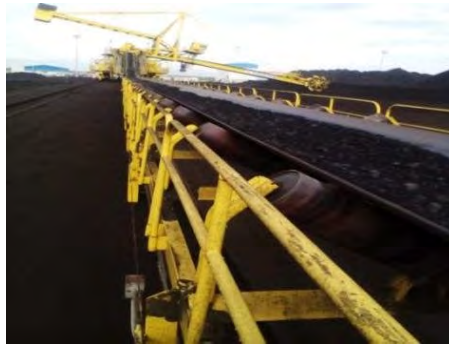
Gambar 2. 1. Belt Conveyor Pengangkut Batu Bara di PLTU.
