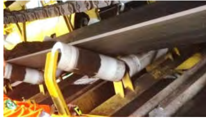
Gambar 2. 3. Roller idler penyangga dan pengarah belt pengangkut
