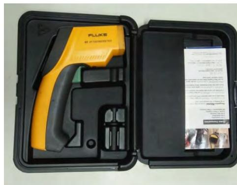
Gambar 3.7 *Thermometer Infra Merah*
