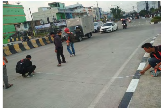
Gambar pengukuran geometrik Jalan Katamso
