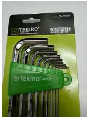
Gambar 3.5 Kunci L merek TERIKO untuk mengikat benda kerja
