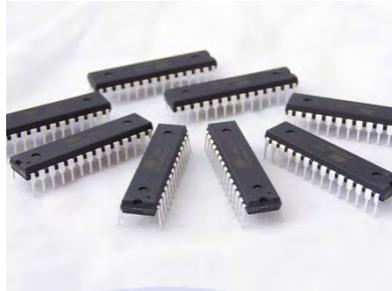
**Gambar 2.1.: Bentuk fisik mikrokontroler**
