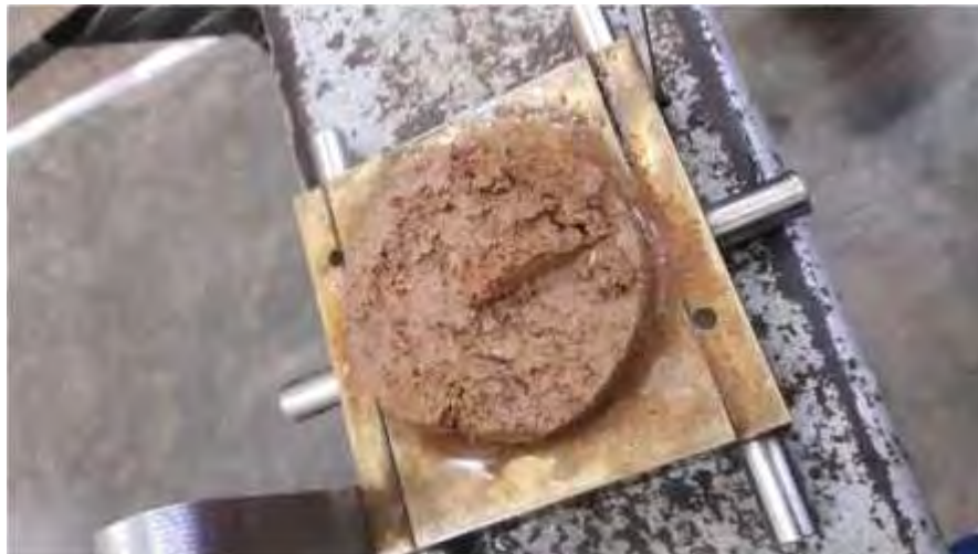
Gambar. Benda uji setelah dilakukan pengujian Direct Shear (Sumber: Penelitian di Laboratorium Politeknik Medau, 2018)
