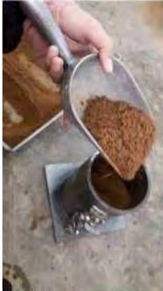
Gambar. memasukkan benda uji ke dalam mold untuk di uji! p. emadnan siandart (compaction) (Sumber: Penelitian di Laboratorium Politeknik Medan, 2018)
