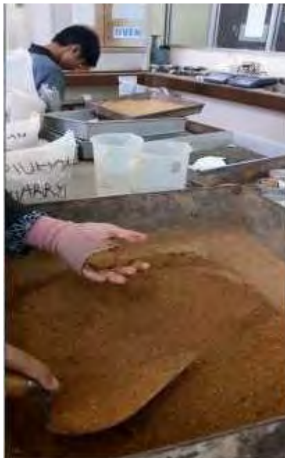
Ciambar. merata1an tanah untuk mcncapai kadar air optimum pada penyujian penzactatan fitandart (cc>mpacti<on) (Numbers PeneTiMan di Lahoratonurfi PoJit'ek.ntk MAzin, *018)
