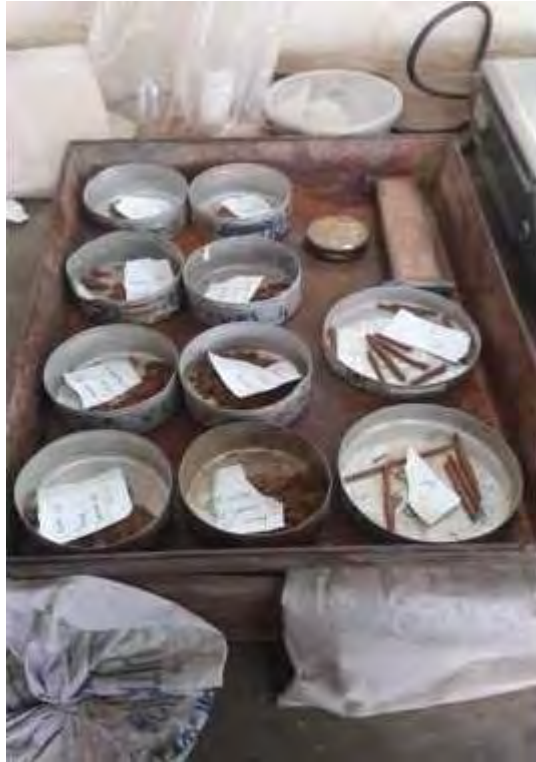
Ciarnbar. benda uji pada pengujian "8atas-barns Atte'berg (Sea]ber: Penelitian di Laboratociurn oliteknik Medan, 20 I BJ
