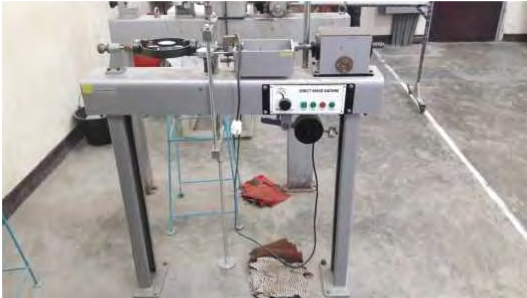
Gambar. Mesin Pcmguji Direct Shear (Surttber. Penal lian di Lsbcnilorium PolitekniiL Medan, 2018)
