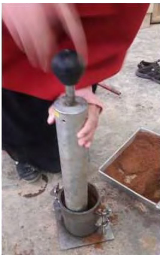
Gambar. Pelaksanaan Pengujian Pemadatan Standard (Sumber: Penelitian di Laboratorium Politeknik Medan, 2018)
