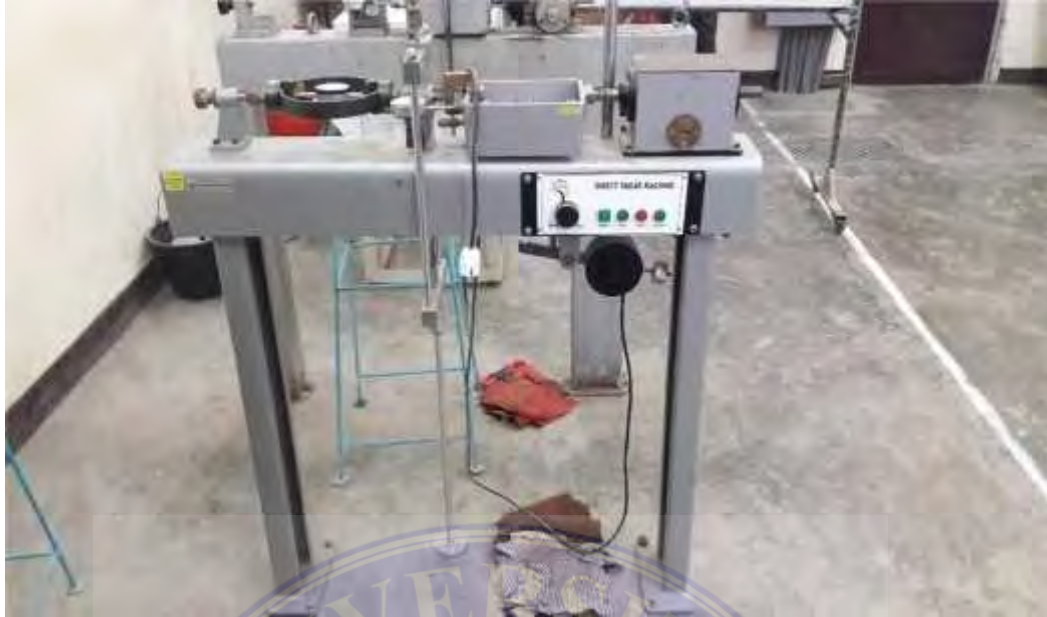
Gambar 2.9: Alat uji geser langsung (Sumber: Laboratorium Politeknik Medan, 2018)
