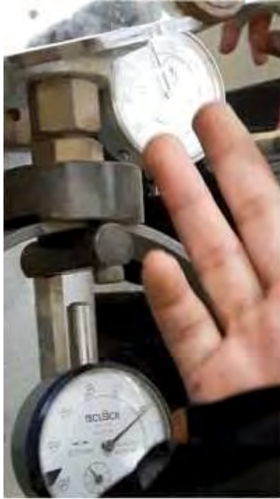
Gambar. Pembacaan 2 buah arloji peaser (extensiometer) untuk mengukur regangan pergeseran uji
