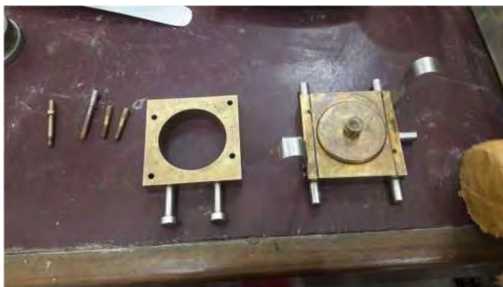
Gambar. cincin pemeriksaan yang terbagi dua dengan penguncinya terletak dalam french total (Sumber: Penelitian di Laboratorium Politeknik Medan, 2018)
