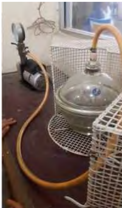
Gambar. Vaccum pum (vakum hampa udara) ilntuk mengeluarkan selunih udara pada pengujian berat Jgnis (fiurrthez. Penelitian di Lahorazodum Politeknik Medan. 2018)
