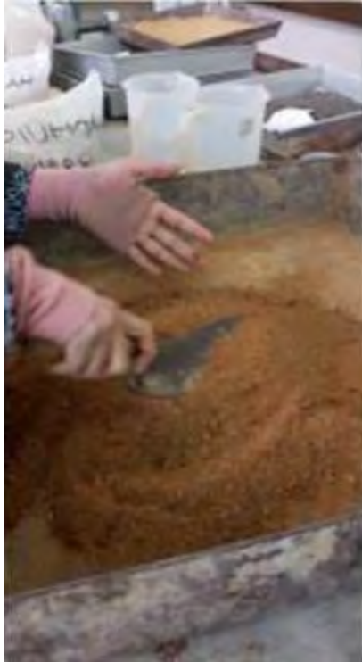
Cambar. merafakan tanah untuk Ttyeocupai ks'dar air optimum pada yen'gujian pematadati Standard (compaction) (Sumber: Penelitian'di Laboracoriuin Politekoik Medan. 2018)
