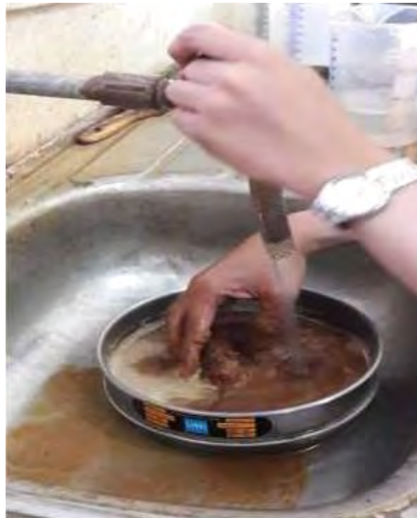
Gambar. benda uji enelisa jaringan yang sedang di cuci untuk mendapatkan jumlah butiran lolos No.200 (Sumber: Penelitian di Laborat◊tium PohtekniL Modan, 2018)
