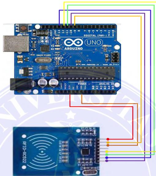
Gambar 3.7: Instalasi modul *Arduino Uno* dengan *RFID-RC522*
