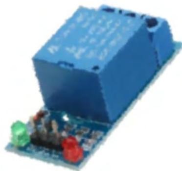
**Gambar 2.7: Bentuk fisik *Relay***
