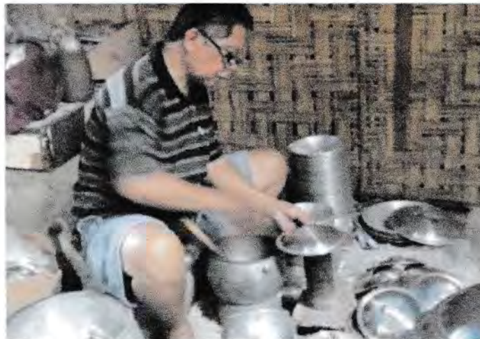
Gambar 3.5. Proses penghalusan dan pengkilatan
