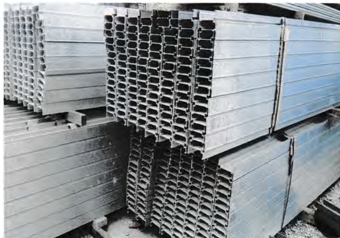
Gambar 4.3 Baja Ringan Aluma Girder Sumber : Data lapangan ,2016
