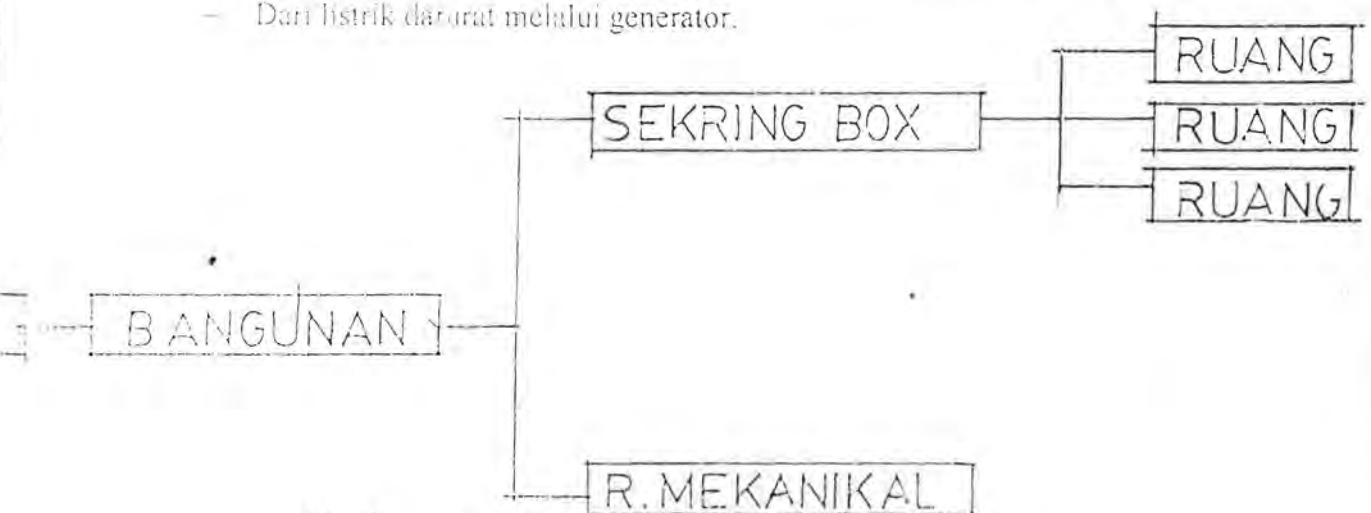
Gambar 7.6 Sistem suplay Tenaga Listrik dari PLN.
