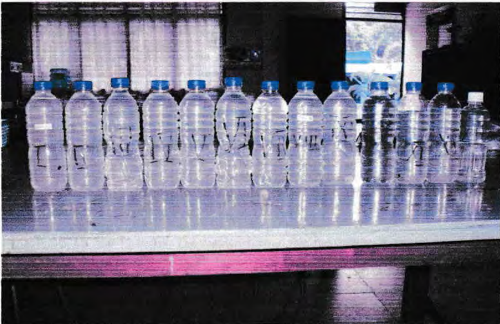
Gambar 8. Sampel air sesudah penjernihan dengan koagulan kitosan cangkang kerang bulu dengan berbagai variasi waktu
