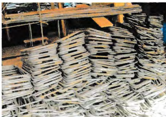
Gambar 2.1c: besi tulangan (mutu baja U39) sumber lapangan
