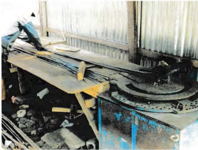
Gambar 2.2d : Bar bender / pembengkok besi tulangan
