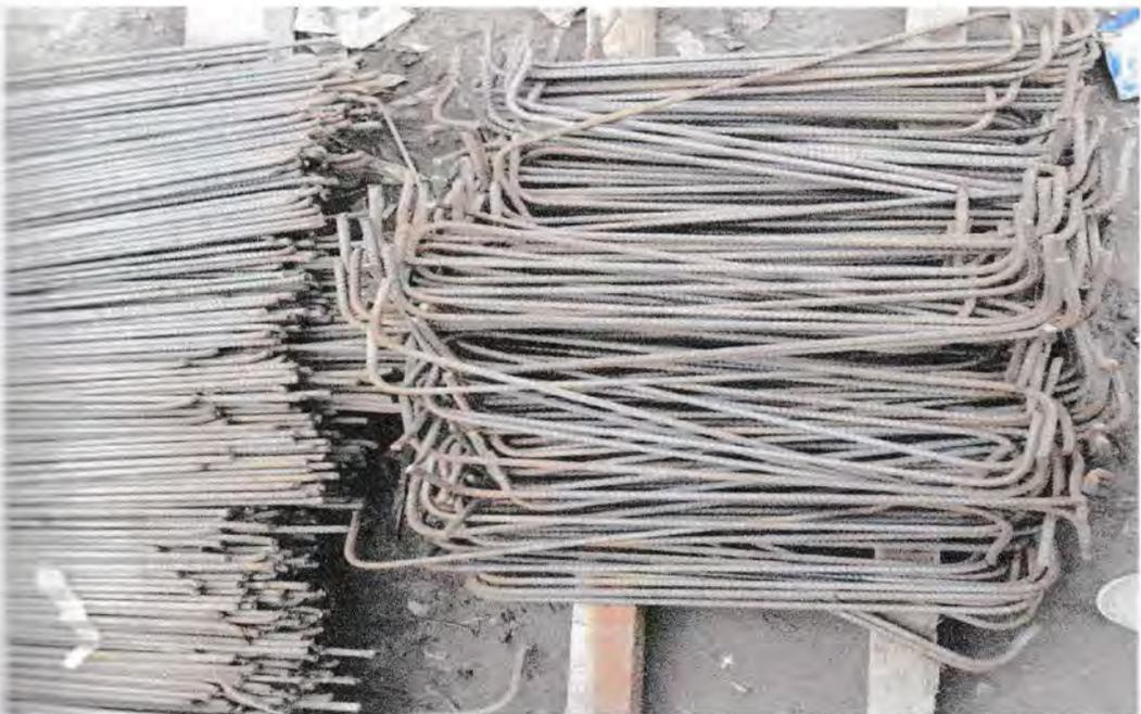
Gambar 4.13 hasil pabrikan dengan alat bar bending dan bar cutter
