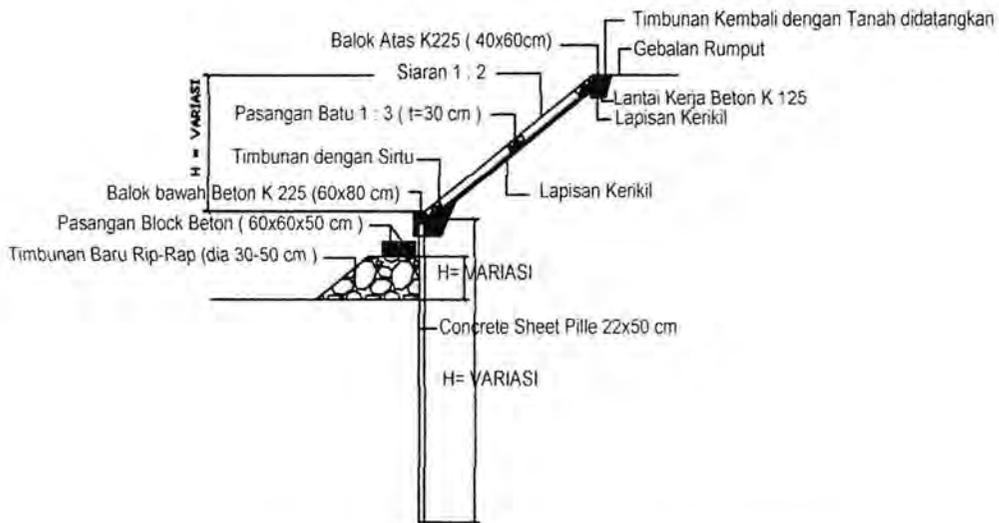
**Gambar Rencana Perkuatan Tebing dengan Sheet Pile Beton**
