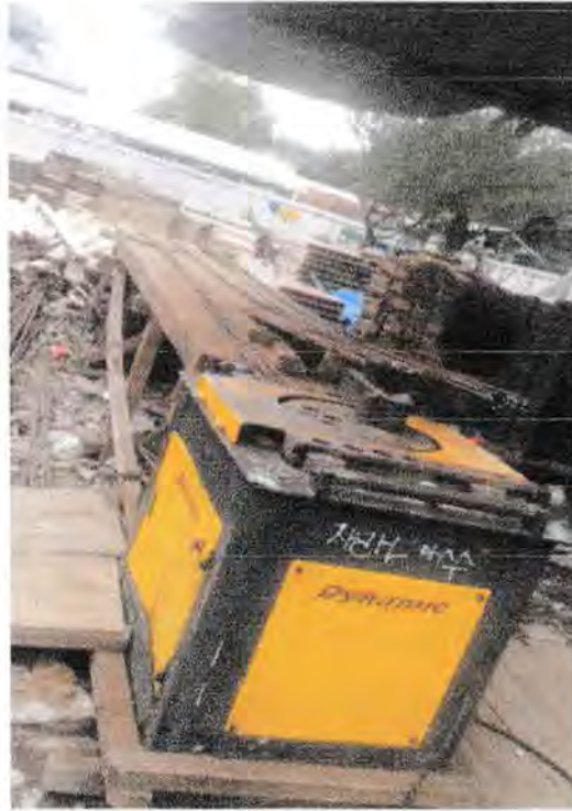
Gambar 3.4 Bar Bender pada proyek PPPPTK
