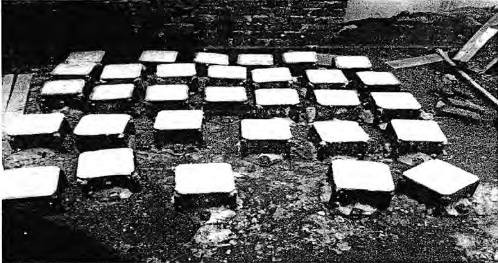
Gambar : Uji test mutu beton
