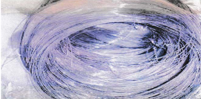
Gambar 3.3 Kawat Beton Sumber : Data lapangan , 2017
