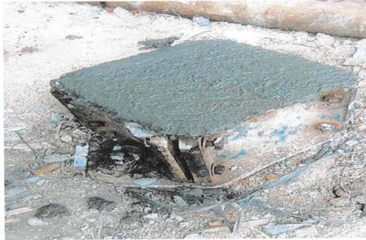
**Gambar 3.9 :** Beberapa sampel dari beton segar untuk uji kuat tekan beton
