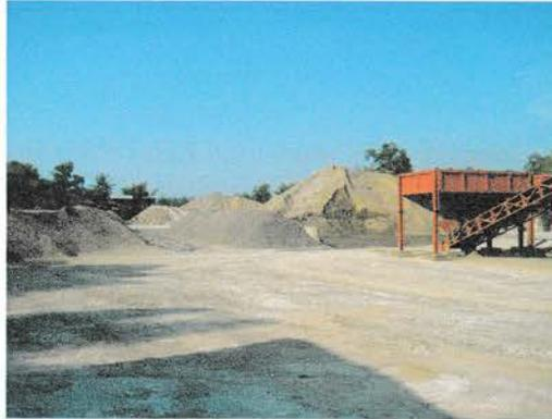
**Gambar 3.1 :** Agregat halus untuk bahan campuran beton
