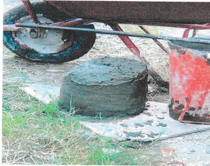
**Gambar 3.8 :** Pengukuran nilai slump pada beton segar, untuk mengetahui tingkat workability dari beton. Syarat ketinggian yang diminta 10-14 cm
