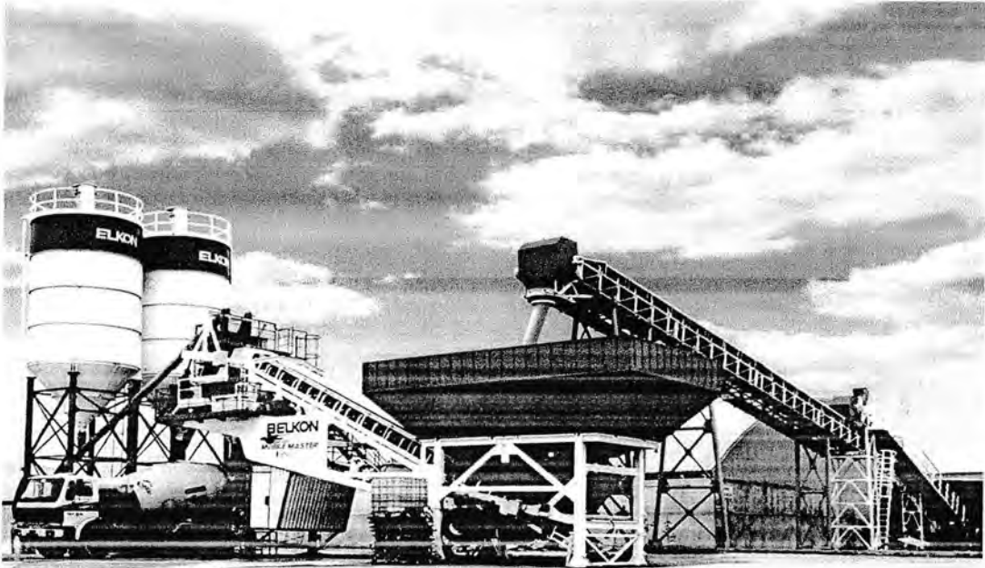
Gambar 3.10 Ready Mix Yang Diolah Pada Batching Plant
