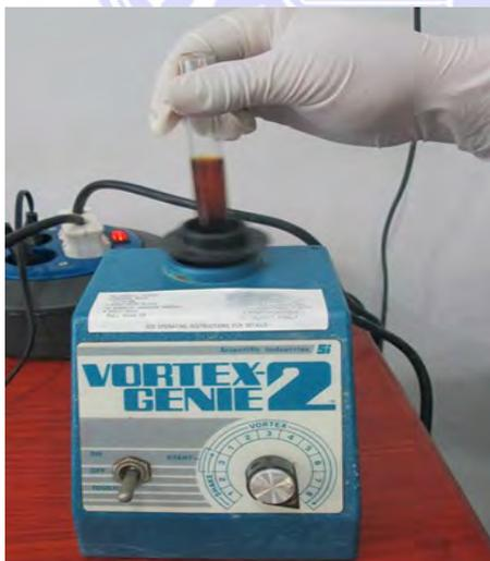
Q. Menghomogenkan Ekstrak Pada Petri Dengan Vortex 2
