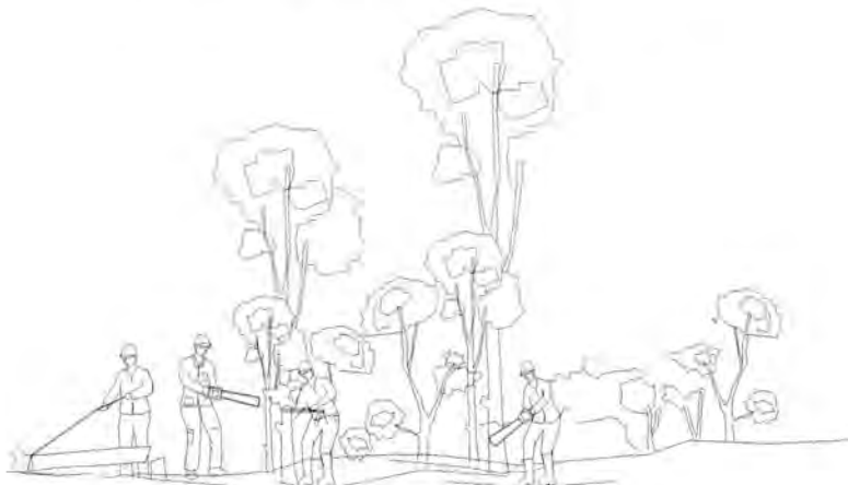
Pengukuran Lokasi dan Pembersihan Meliputi Pemotongan Pepohonan Sepanjang Jalur Lintasan
