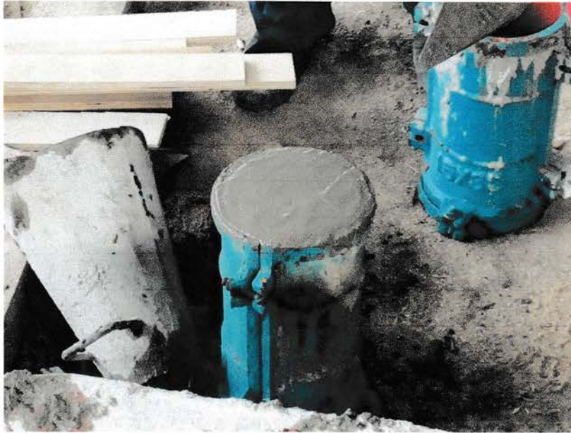
Gambar : Uji kekuatan beton
