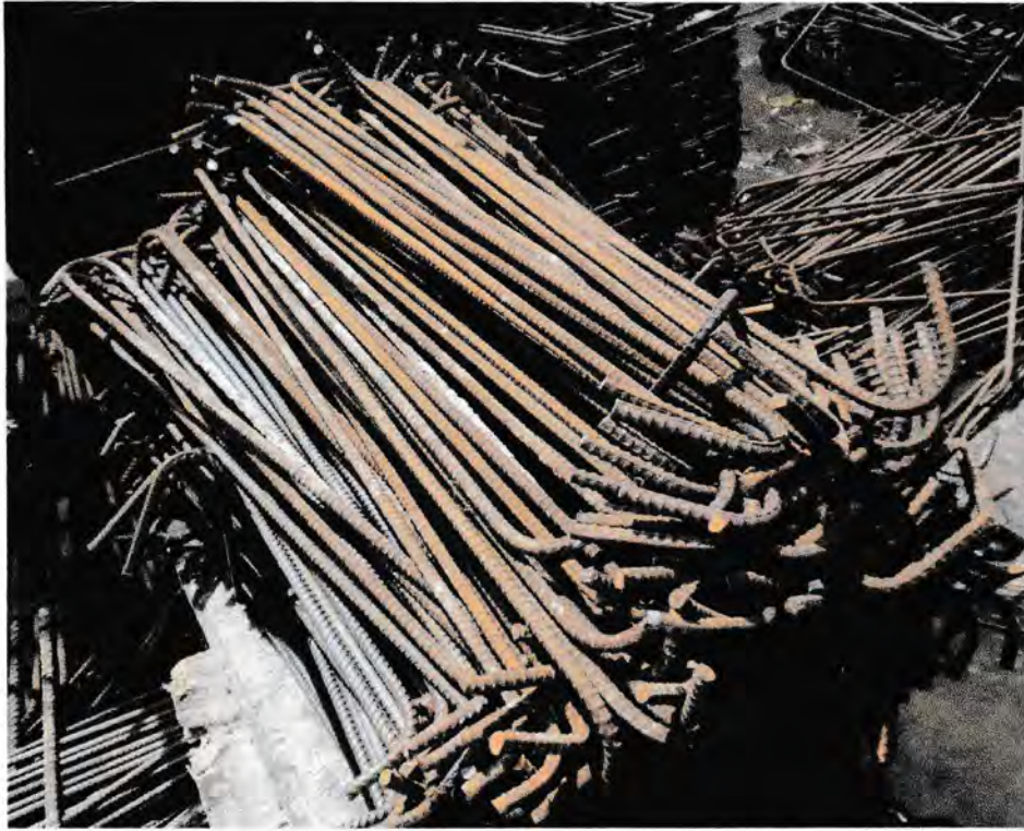
Gambar : Besi tis yang dikerjakan dipabrikasi
