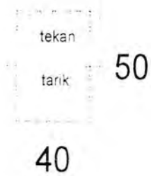
Gambar 4.1d. Penampang kolom induk lantai 1 uk. 40/50 cm (jika dikonversi)
