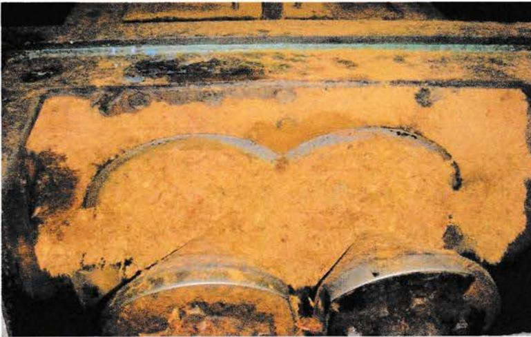
Gambar 28 : *Screw Press* tempat pemerasan
