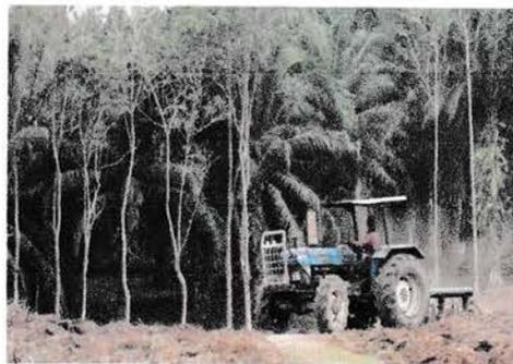
Gambar 15. *Wheel Tractor* untuk pencangkulan tanah setelah *ripping*
