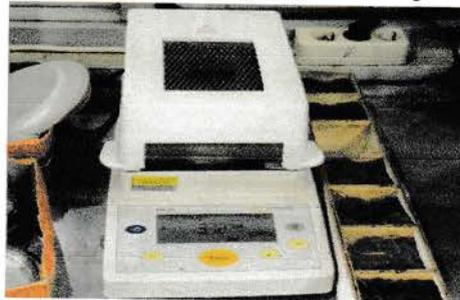
Gambar 54. Alat pengukur kadar air pada teh
