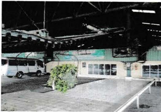
Gambar 38. Proses pengangkutan pucuk basah menggunakan monorail
